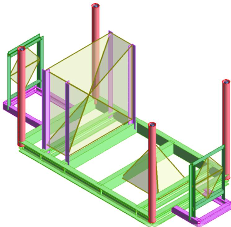
Châssis de support de batterie de refroidissement
